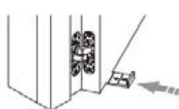
② Schieben Sie den Keil unter die Tür, bis der gewünschte Bodenabstand erreicht ist. Nun die Schrauben wieder anziehen.
