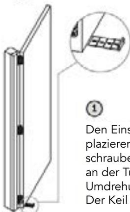
① Den Einstellkeil unter der Tür plazieren. Dann die Befestigungsschrauben, mit der das Scharnier an der Tür befestigt ist, eine Umdrehung herausdrehen. Der Keil bleibt unter der Tür.
