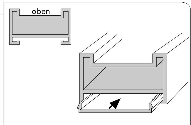
**Vor dem Verschrauben Einschiebeblech in die Nut des AD einschieben und über dem Türbereich positionieren. Das Einschiebeblech bestimmt die Türbreite incl. des Abstandes (Luft) an der Schloss- und Bandseite!**
