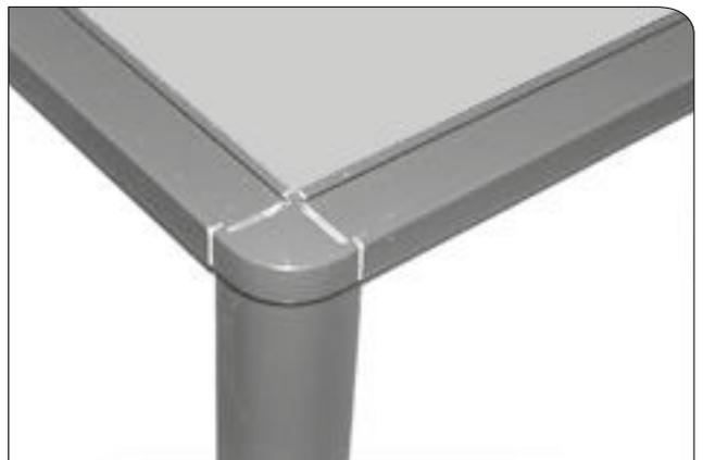
Die AD30 der Vorderfront und der Seitenwand mit dem Eckverbinder zusammenstecken, auf die Anlage aufsetzen und mit 5 x 60 mm Schrauben verschrauben.
