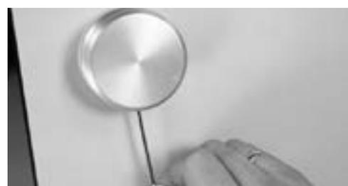
Den Knopf nun durch den Schloßkasten einsetzen. Die Abgeflachte Seite des Vierkants muss nach unten zeigen.
