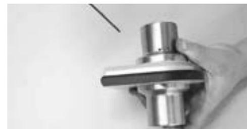
Mit einem 2,5 mm Inbus wird nun der Drehknopf, unter Druck auf den Vierkant, von der Rot-Weiß-Seite verschraubt.
