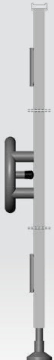
Aluminium stelroot met in hoogte verstelbare nylon pootrozet
